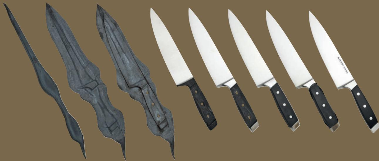
Die Fertigung eines Felix-Messers – vom Messerrohling bis zum fertigen Produkt durchläuft ein Messer ca. 45 Arbeitsgänge. Die meisten davon von Hand.
