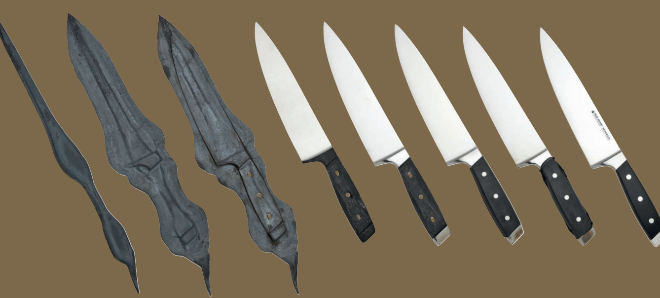
Die Fertigung eines Felix-Messers – vom Messerrohling bis zum fertigen Produkt durchläuft ein Messer ca. 45 Arbeitsgänge. Die meisten davon von Hand.
