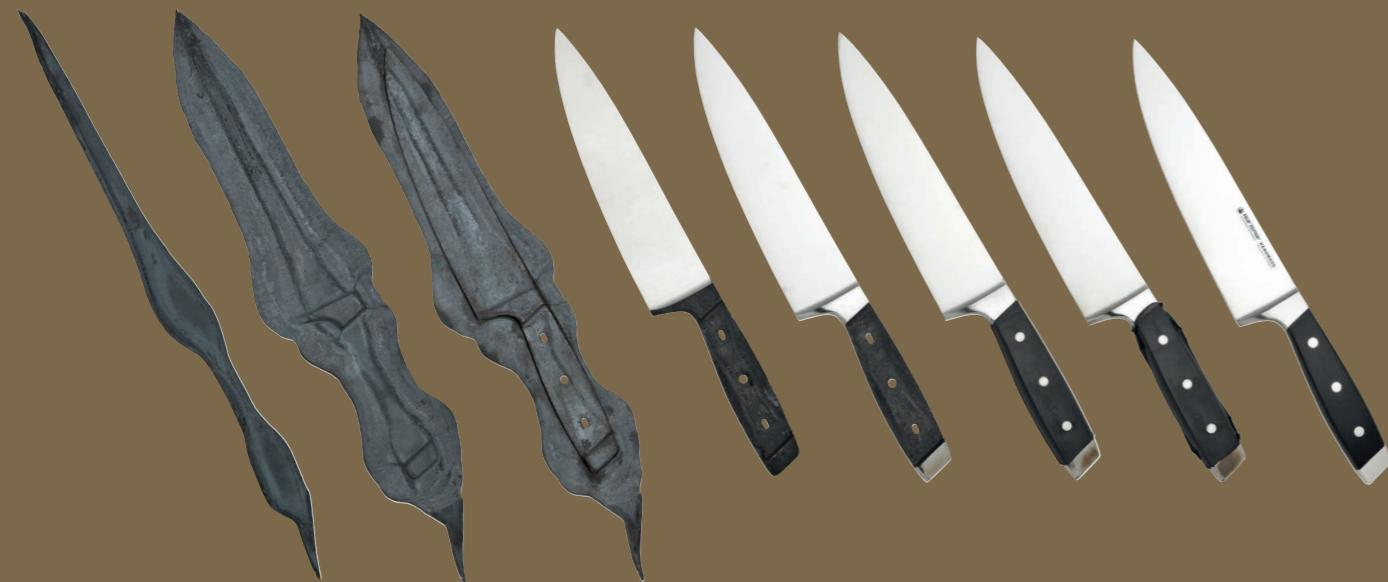
Proizvodnja Felix noževa – nož se obrađuje kroz 45 postupaka, od štancovanog komada do gotovog proizvoda. Većina postupaka radi se ručno.
